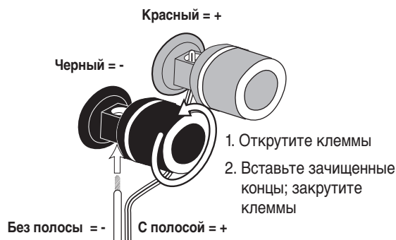
Рис. 1. На этом рисунке показано, как подсоединить зачищенные провода к клеммам
